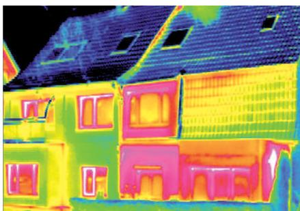
Eine Vielzahl von Wohngebäuden sind noch mit alten Fenstern ausgerüstet, welche ein gering dämmendes Glas und oftmals auch undichte Rahmenfugen aufweisen. Solche
